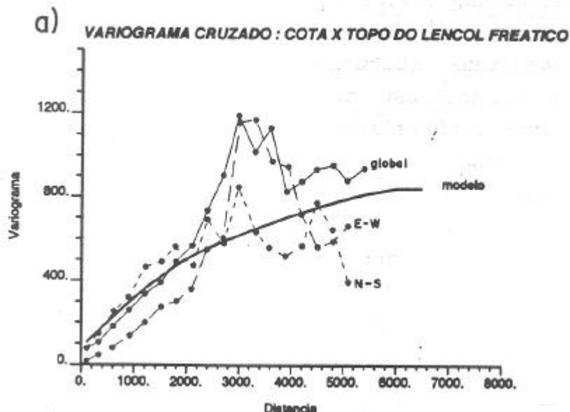
Figura 6 - Variograma cruzado da cota topográfica com o topo do lençol freático.
